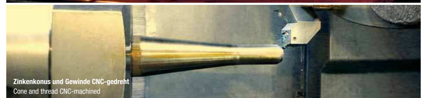
Zinken: vergütet, gehärtet und angelassen, Sollhärte 45 – 49 HRC Tines: heat-treated, hardened and tempered, nominal hardness 45 – 49 HRC
