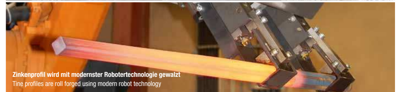
Material: Silizium-Federstahl, profilgewalzt, aus deutscher Herstellung Material: Silicon manganese spring steel, roll forged
