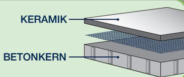
Die Serie COMPOSITO verbindet die Vorteile einer keramischen Platte mit denen einer Betonplatte. Kratzfeste, pflegeleichte und witterungsbeständige Oberflächen sind dabei auf einem hoch verdichteten Betonkern kraftschlüssig angeordnet.
