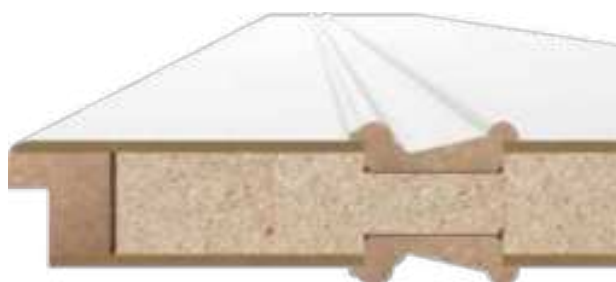
Schnitt Cottage, Standardeinlage VSP
