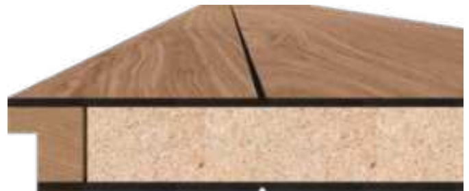
Schnitt Nero, Alternativeinlage VSP
