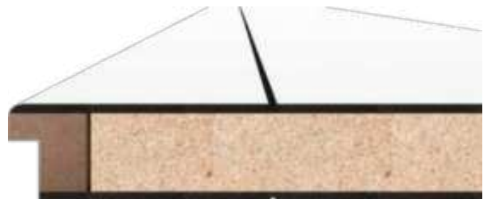
Schnitt Nero, Alternativeinlage VSP
